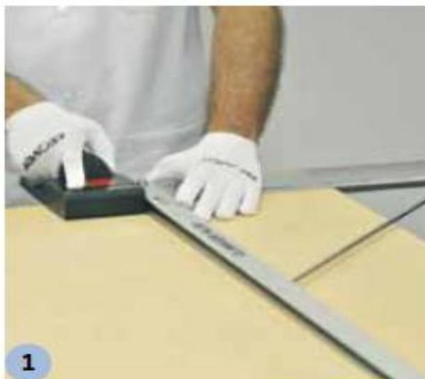
2. Colocar o esquadro com a outra medida interna, "b". A medida deverá ser contada a partir da segunda linha de corte. Passa a ferramenta vermelha.
